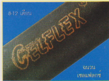
รูปที่ 2 จากการทดสอบโดยการนำไปตากแดด ตากฝน ภายใต้บรรยากาศจริงในประเทศไทย พิสูจน์ให้เห็นว่าฉนวนเซลแฟล็กซ์มีความหนาแน่นต่อสภาวะอากาศต่าง ๆ ได้ดีกว่าฉนวนพลาสติกและฉนวนยางบางยี่ห้อ ซึ่งเป็นผลเป็นลาย หรือเป็นวง และเสื่อมสภาพเป็นฉนวนที่ด้อยในระยะเวลายาวขึ้น
