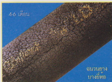
รูปที่ 2 จากการทดสอบโดยการนำไปตากแดด ตากฝน ภายใต้บรรยากาศจริงในประเทศไทย พิสูจน์ให้เห็นว่าฉนวนเซลแฟล็กซ์มีความหนาแน่นต่อสภาวะอากาศต่าง ๆ ได้ดีกว่าฉนวนพลาสติกและฉนวนยางบางยี่ห้อ ซึ่งเป็นผลเป็นลาย หรือเป็นวง และเสื่อมสภาพเป็นฉนวนที่ด้อยในระยะเวลายาวขึ้น
