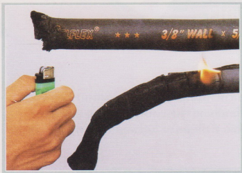
รูปที่ 1 การทดสอบการติดไฟโดยใช้ไฟแช็คจนเป็นเวลา 15 วินาที แล้วนำไฟออก จะเห็นว่าเซลแฟล็กซ์เป็นฉนวนชนิดไฟดับได้เอง ขณะที่ฉนวนยางบางยี่ห้อจะติดไฟ และลามไฟ อาจเป็นสาเหตุการเกิดเพลิงไหม้ได้
