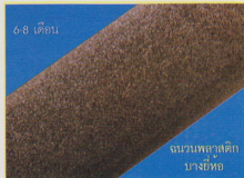
รูปที่ 2 จากการทดสอบโดยการนำไปตากแดด ตากฝน ภายใต้บรรยากาศจริงในประเทศไทย พิสูจน์ให้เห็นว่าฉนวนเซลแฟล็กซ์มีความหนาแน่นต่อสภาวะอากาศต่าง ๆ ได้ดีกว่าฉนวนพลาสติกและฉนวนยางบางยี่ห้อ ซึ่งเป็นผลเป็นลาย หรือเป็นวง และเสื่อมสภาพเป็นฉนวนที่ด้อยในระยะเวลายาวขึ้น
