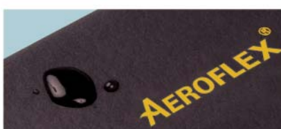
ฉนวนแอโรฟลักซ์ ที่ผลิตจากสารอีลาสโตเมอร์ชนิดพิเศษซึ่งมีโครงสร้างทางเคมีที่ทนต่อน้ำและความชื้นสูงประกอบด้วยสภาพผนังเซลล์อิสระหลายชั้นจึงทำให้ฉนวนแอโรฟลักซ์มีการเปลี่ยนแปลงค่าสัมประสิทธิ์การนำความร้อนต่ำตลอดอายุการใช้งาน
