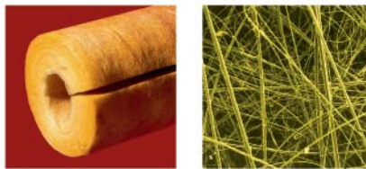
ฉนวนใยแก้ว (Fiberglass) ฉนวนชนิดเซลล์เปิด ชนิดเส้นใย (Open Cell) ภาพจากกล้องจุลทรรศน์อิเล็กโตรนิกขยาย 30 เท่า จะสามารถเห็นภาพโครงสร้างภายใน ซึ่งมีลักษณะเป็นเส้นใย ทำให้มีการดูดซึมน้ำและความชื้นและนำส่งมากที่สุด
