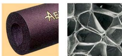
ฉนวนแอโรฟลักซ์ (Aeroflex) ฉนวนชนิดเซลล์ปิด (Closed Cell Structure) ภาพจากกล้องจุลทรรศน์อิเล็กโตรนิกขยาย 20 เท่า จะสามารถเห็นโครงสร้างเซลล์ปิดซึ่งมีลักษณะผนังเซลล์กันอิสระไม่ต้องเชื่อมกัน
